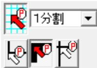
グリッド吸着をON、線吸着をOFF、壁芯吸着をONにします。
