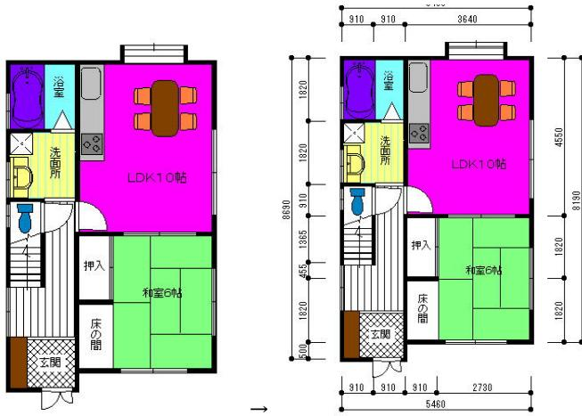
できあがった寸法線で思ったようにできていない部分は「選択」で選択してから削除して、「寸法線」ツールで書き直してください。線吸着がONになっていますと寸法線の足に吸着するので書きやすくなります。また、寸法値を変えたい場合は書き直すか、選択して「ツール」「線化・線結合」「寸法線の文字線化」で線と文字にして右クリックから「選択文字の修正」をします。
