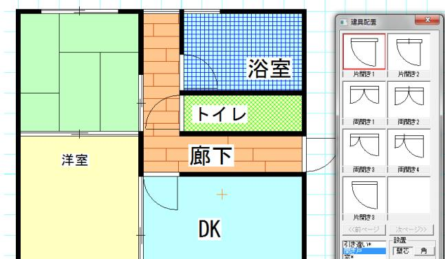
「建具配置」で建具を配置します。階段がある場合は「階段作成」で階段を作成します。
