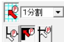
グリッド吸着をON、線吸着をOFF、壁芯吸着をONになります。
