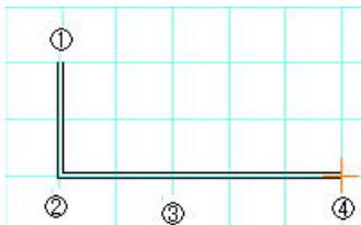
上記の4までクリックし、「アール作成」ボタンを押すと2つ前のクリック位置を始点とし、1つ前のクリック位置を終点とするアール部分が作成できます。通常の円弧と違い、分割数分円弧上にポイントをとったことになります。分割数は多いほどより円弧に近い作図ができますが、作図が重くなったりしますので、図面の精度にあわせて分割数を選んでください(24~26くらいで充分細かくとれます)。
