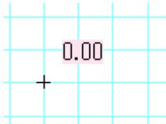
次に一点目をクリックした同じ場所で SHIFT ボタンを押しながら左クリックします。次の相対位置入力画面が出ます。その位置より左方向に3000mmいたところに二点目をとりたいので上に3000と入力します(もし左方向なら-3000、上方向なら下の入力ボックスに 3000、下方向なら下のボックスに-3000と入れます)
