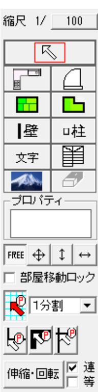
◆ 縮尺 1/ 100 「縮尺」…印刷図面の尺度をキーボードから入力して変更します。
