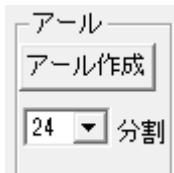
「アール作成」を押すと円弧の大きさを決めます。円弧の大きさがきめににくい場合は一時的にグリッド吸着をOFF(もしくは分割数を増やす)にしてください。左クリックで確定です。
