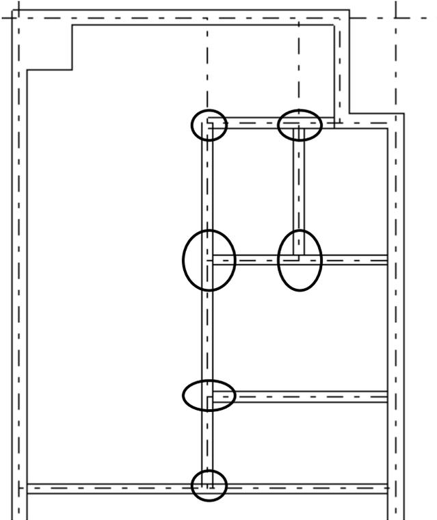
上の図の丸印を「包絡」します。もしうまく包絡できなかった時は「線伸縮」をしてください。上の図の通り線をひきますと、うまく包絡できます。
