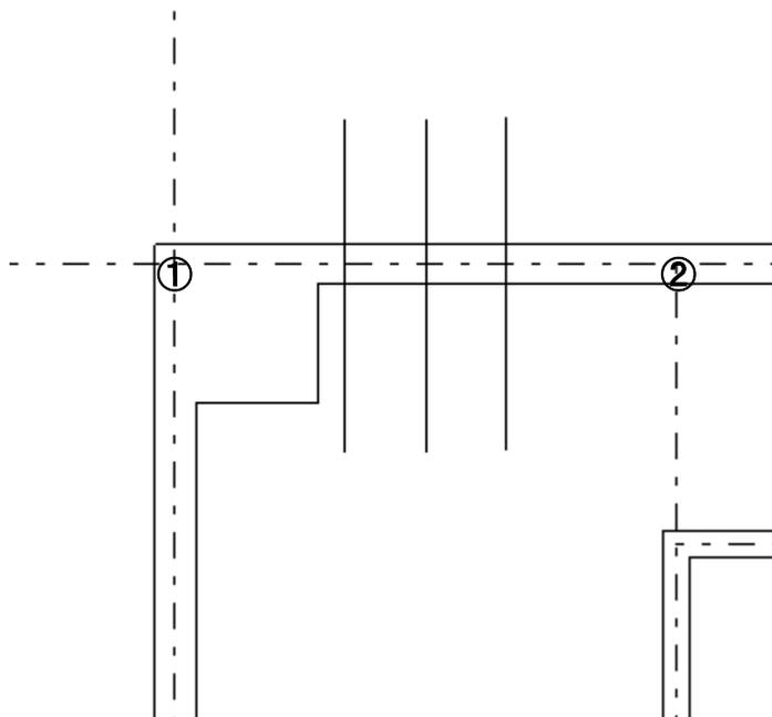
吸着をOFFにして、「線切断」で下図「切」印 2箇所をクリックします。①と②、①と③、④と⑤、④と⑥をそれぞれ「コーナー処理」します。
