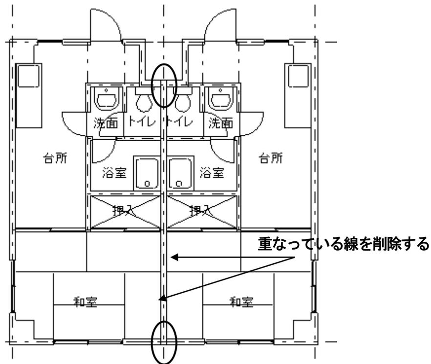
重なっている部分に文字「PS」を入れ、レイヤー0-6 にしてレイヤー名称を「仕上げ」として、芯上に 800×30 の仕上げパネルを寸法指定四角形で配置します。
