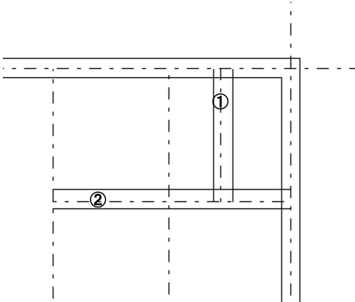
次に「ツール」「変形」「コーナー処理」で以下の図のようにします。「線伸縮」でもできますが、この場合「コーナー処理」の方がラクにできます。
