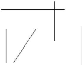
「ツール」「線編集」「線伸縮」を選んで、横向きの線を最初にクリックしてください。この最初にクリックした線が基準線になります。他の線を順にクリックしていきます。基準線との交点まで線が伸縮します。基準線と対象線が交わっている場合は、クリックした側の線が残ります。
