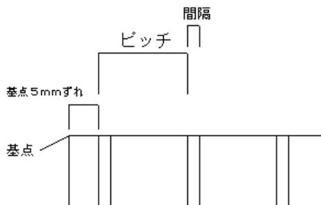
使用例:「ファイル」→「サンプルファイルを開く」で「マンション」を開きます。レイヤー0-1(躯体)のレイヤーを「レイヤー」→「レイヤー全選択状態」で全て選択状態にし、右クリックメニューより「ハッチ作成」を開きます。
