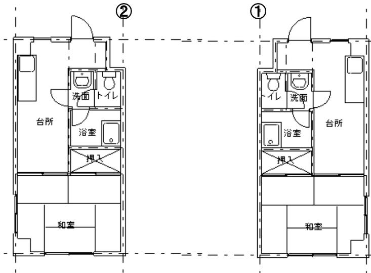
属性取得で「躯体」にし、重ね合わさっている線を削除、丸印を包絡処理してください。
