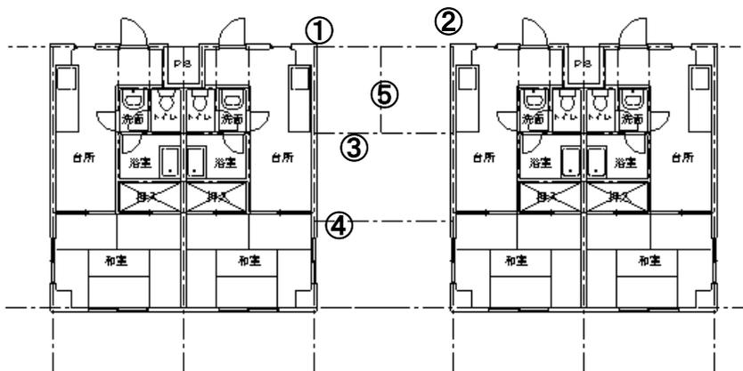
レイヤー0-1の躯体にして、2線(75, 75)で線を引き、包絡、コーナー処理等で下記のように線を処理します。
