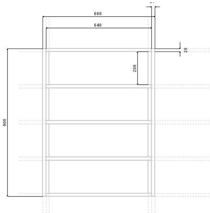
20mm の短い間は、その間の寸法線を削除し、「作図」「直線」
