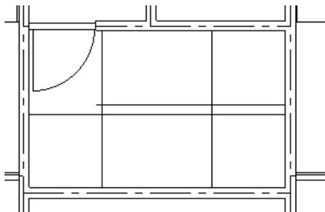
線伸縮で処理して、分割線で6分割した線をひきます。
