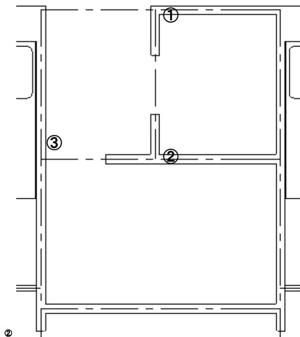
レイヤー0-3 の建具にして幅 1000mmの部品配置で、「引違い」の「引き違い2枚ココ」。線吸着を利用して配置し、右クリックから移動
