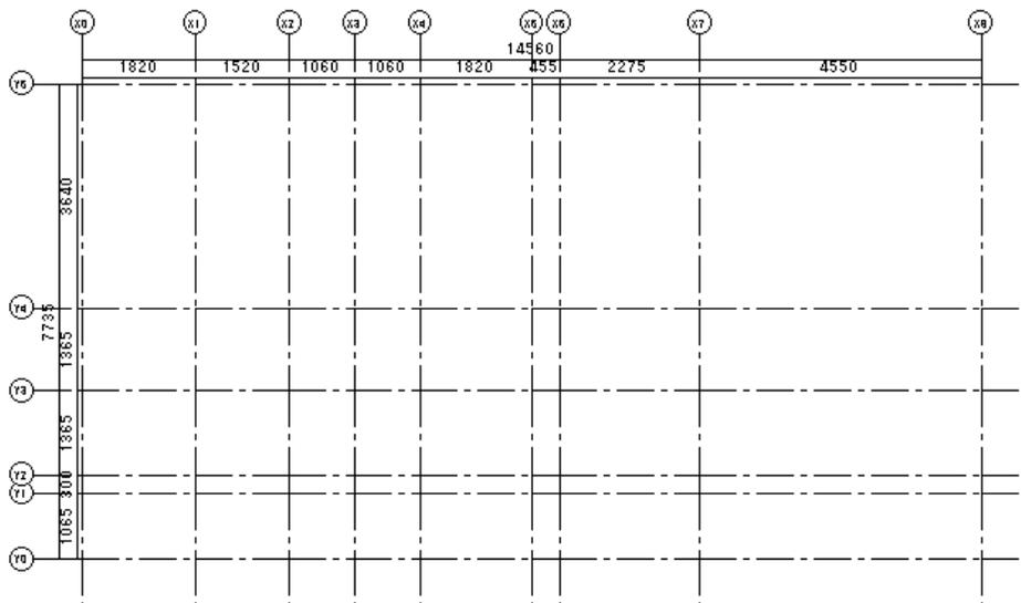
上記通り芯では線吸着で交点ごとに吸着しますが、操作スピードが遅くなったりしますので、通り芯で吸着を利用したい場合は、補助線グリッドを使うことをお勧めします。
