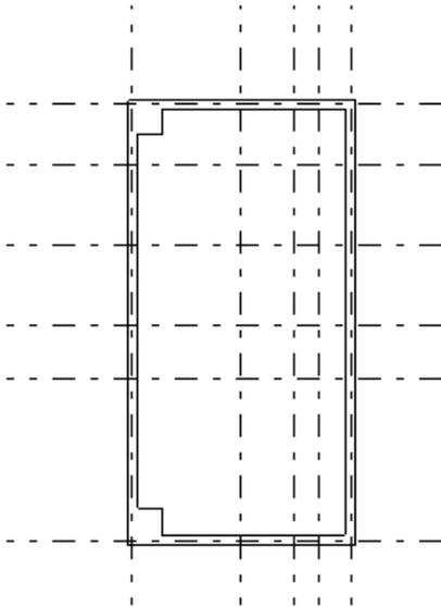
「ツール」 「線編集」 「線伸縮」 で間仕切り芯を以下の図のように伸縮します。
