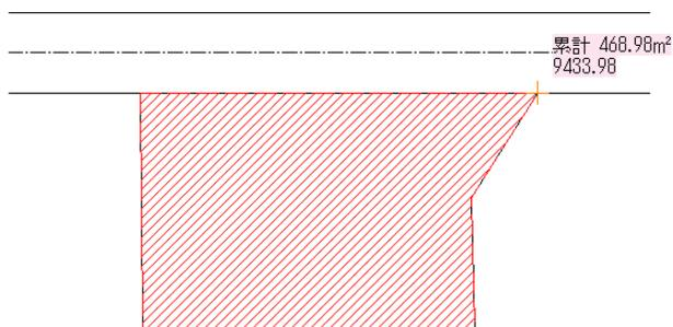
ツールの測定で「長さ累計」を選び、面積と同じように頂点をとっていくと、最後の点が最初の点までいったらダブルクリックすると、外周がでできます。
