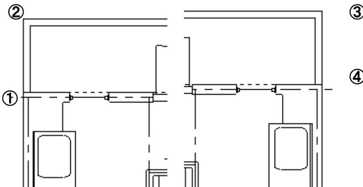
次はバルコニーです。廊下と同じように作成しますが、二重線を使います。「作図」の「二重線」で進行方向右側を0、左側を100にします。図面の左下の和室の下側の部分で、下記①をクリックし、同じ位置で shift+クリックで下方方向に1125を入力して②を作成します。右
