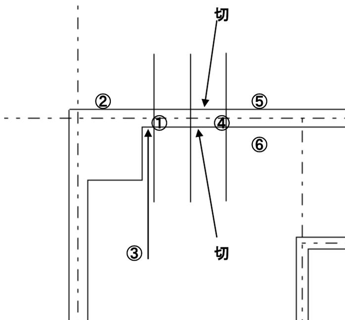
同様に他の外部建具を入れるように躯体を処理していきます。下記芯の①と②の間の中心を 800、③と④の間の中心を 1300、③と⑤の間の中心を 1700 空けるように「コーナー処理」します。
