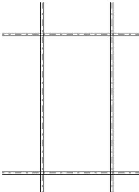
線吸着をOFF、交点吸着をONにし、「四角」を選び、実線にします。左上の交差部分をズームで拡大します。
