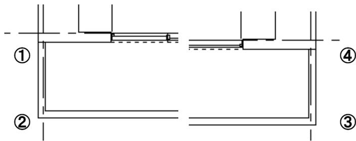
バルコニーの中に仕切り版を作成します。下記①と②を交点吸着で分割線を2分割で下記のような線をひきます。
