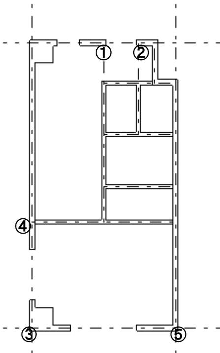
では③から⑤の部分拡大し、レイヤー0-3、レイヤー名称を「建具」として、「部品配置」の「建具」「引違い」の「引き違い2枚ヨコ」を配置し、右クリック「伸縮」で下記の幅に伸縮して、線吸着ONにして下図の位置に配置します。
