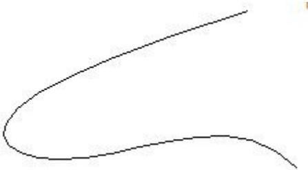
線結合するには必ずポイントが重なり合わないといけないので、線吸着のみONにします。
