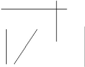
「ツール」|「線編集」|「線伸縮」を選んで、横向き線を最初にクリックしてください。この最初にクリックした線が基準線になります。他の線を順にクリックしていきます。基準線との交点まで線が伸縮します。基準線と対象線が交わっている場合は、クリックした側の線が残ります。
