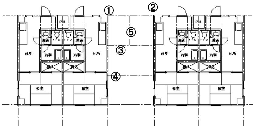
階層 0-1 の躯体にして、2 線(75, 75)で線を引き、包絡、コーナー処理等で下記のように線を処理します。
