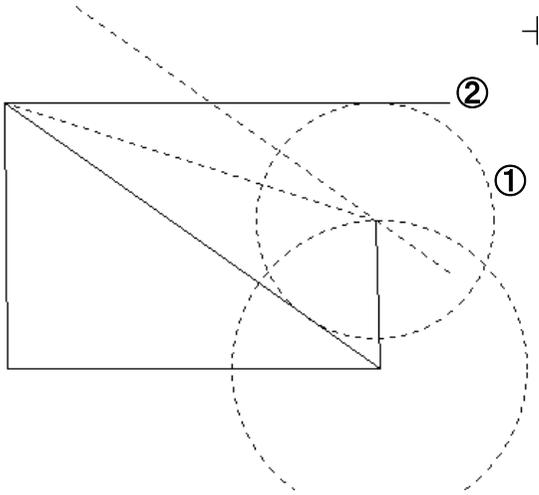
今描いた線の右端と先ほどの円の中心を結べば敷地ができあがります。ツールの「補助線全削除」を選べば余計な線は消えます。「線消」を選び、あと一つ残っている余計な実線をクリックして、「削除」しましょう。
