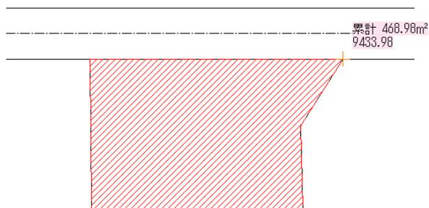
ツールの測定で「長さ累計」を選び、面積と同じように頂点をとっていき、最後の点が最初の点までいったらダブルクリックすると、外周がでできます。
