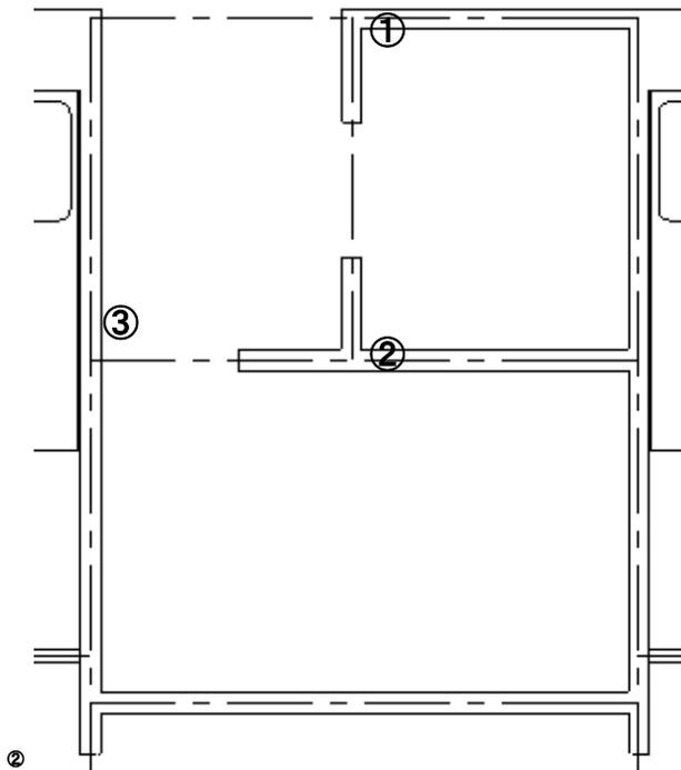
階層 0-3 の建具にして幅 1000mmの部品配置で、「引違い」の「引き違い2枚ヨコ」。線吸着を利用して配置し、右クリックから移動で 25
