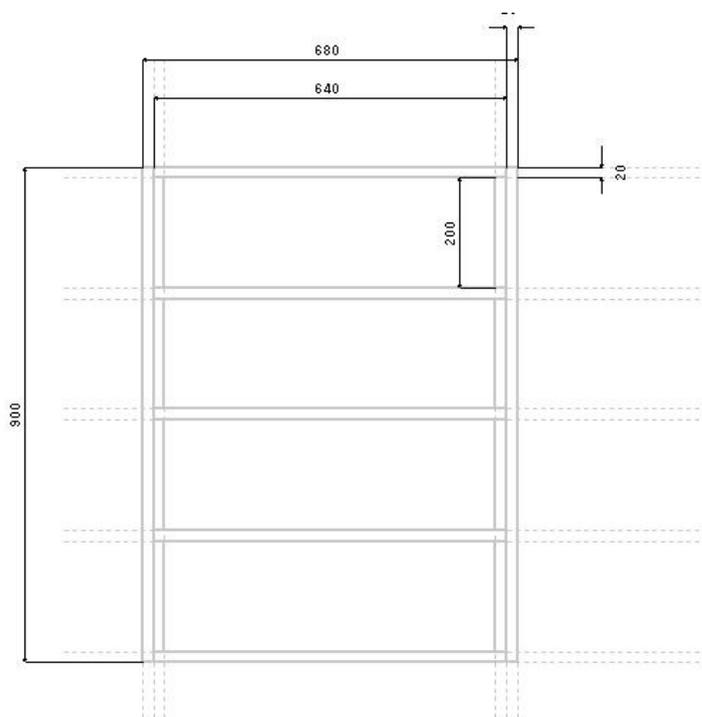
20mm の短い間は、その間の寸法線を削除し、「作図」 「直線」
