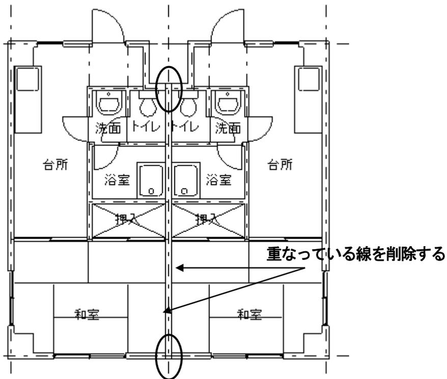
重なっている部分に文字「PS」を入れ、階層 0-6 にして階層名称を「仕上げ」として、芯上に 800×30 の仕上げパネルを寸法指定四角形で配置します。
