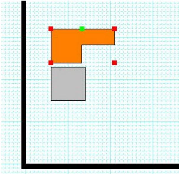
例えば、機械と機械の間が 30mm とかいう場合、正確に書くと 1/100 で 0.3mm なので印刷図面では見えません。間をあけているのを示すためにも、1マスあけて配置したほうがわかりやすいです。
