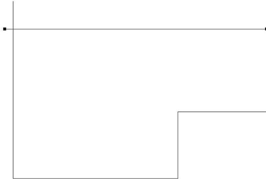
最終点と始点が合わない場合は、「ツール」「変形」「コーナー処理」で処理します。
